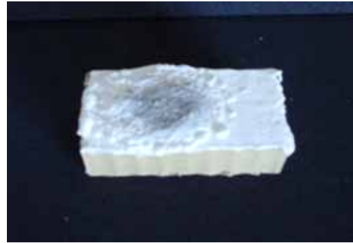
(左は 1,300 のバ - ナ - での加熱実験・基材はダンボール、右は加熱後の発泡状態)
